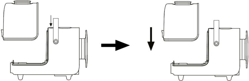
2-Connecter le tuyau d'aspiration à la base de l'appareil.
