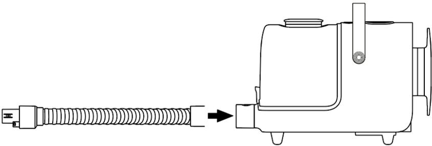
3-Selectionner un accessoire et connecter le à l'autre extrémité du tuyau d'aspiration.
